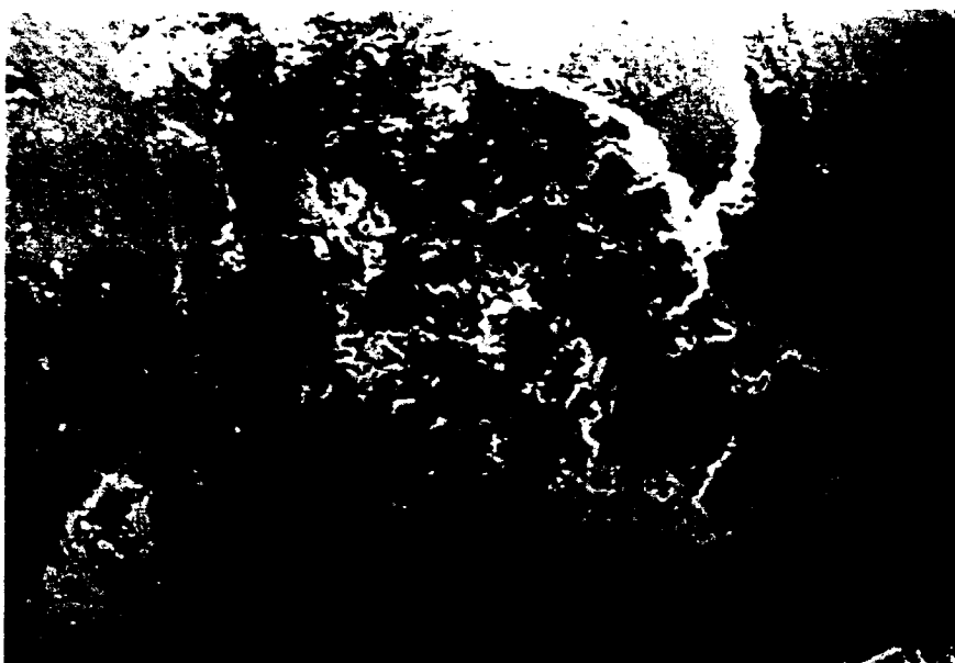
شکل ۴-۸۳) نمونه ۴، سایش در سرعت 0.25 \text{ m/s} ، تحت بار 200 \text{ N} ، ترک‌های عرضی به که نسبت به جهت سایش، حالت عمودی دارند (SEM، بزرگنمایی \times 500 ).
